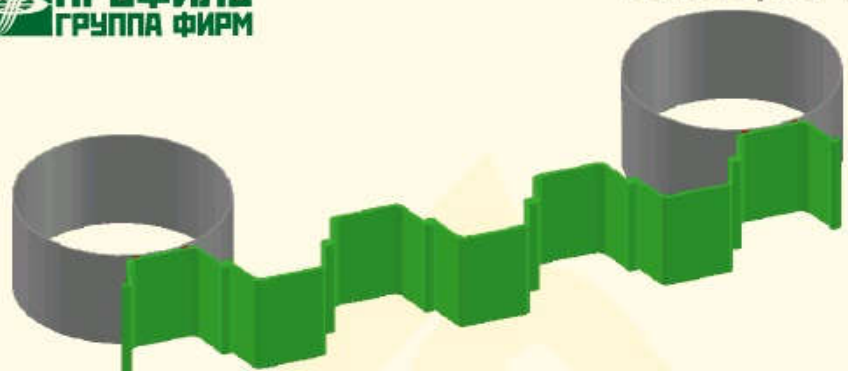
Рис. 9. В качестве усиливающей сваи используется труба (замкнутая/незамкнутая).
