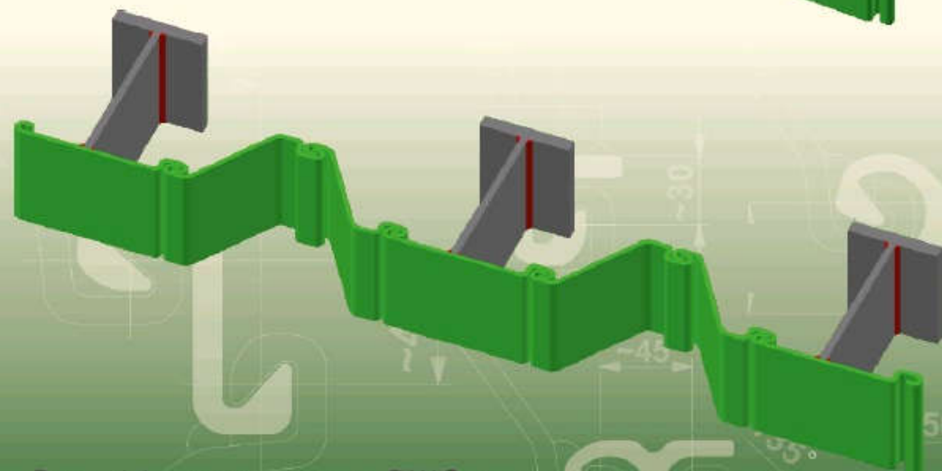
Рис. 14 - компактная РШС с плоским шпунтом и z-профилем и несимметричными замками.
