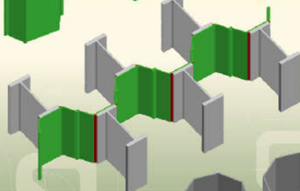
Рис. 3. Двухсторонняя базовая РШС.
