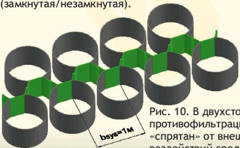
Рис. 9. В качестве усиливающей сваи используется труба (замкнутая/незамкнутая).
