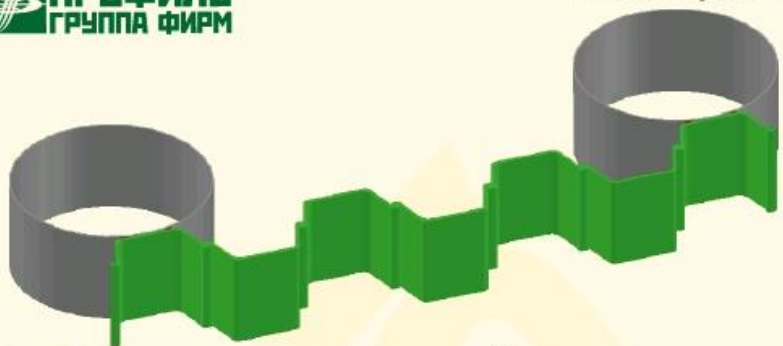
Рис. 9. В качестве усиливающей сваи используется труба (замкнутая/незамкнутая).
